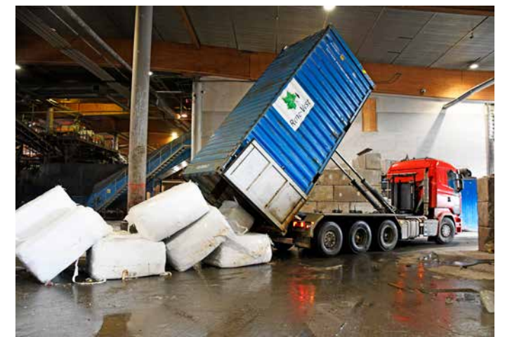
Optisk avfall tømmes inn i optibaganlegget for sortering.
