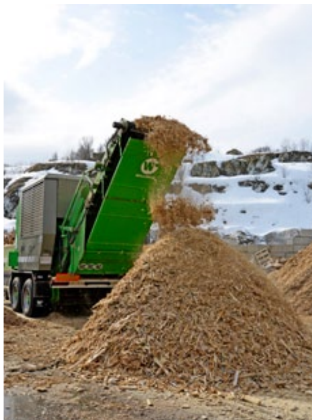
Hageavfall i Tromsø brukes til å varme opp universitetsområdet og sykehuset, etter først å ha blitt kvernet i fliskutteren Shark2.
